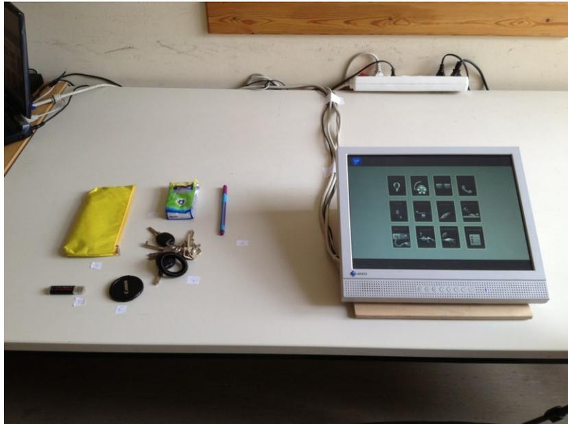
Abbildung 60 Touch Panel mit SEDIOR Prototypen und Gegenstände der Sekundäraufgabe.
