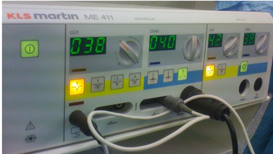
Abbildung 21 Frontpanel eines HF Generators KLS Martin.
