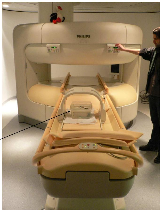
**Abb. 8-10** Messung der MRT-Kompatibilität
