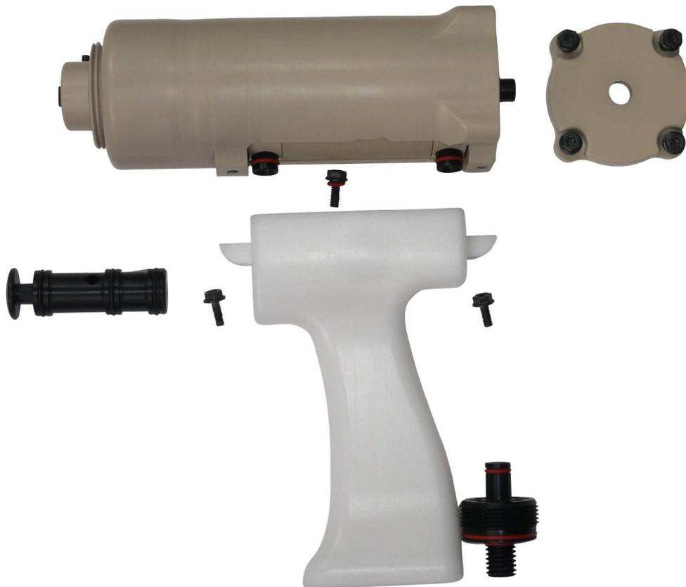
**Abb. 7-9 Gehäuseteile und Handgriff**
