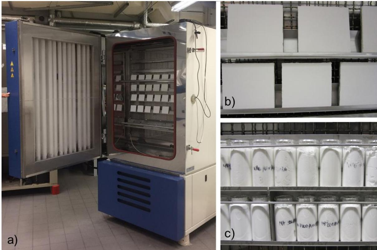
Abbildung 10: a) Bewitterungsgerät der Firma Weiss - Technik b) Beschichtete Substrate im Bewitterungsgerät c) Pulvrige Proben im Bewitterungsgerät
