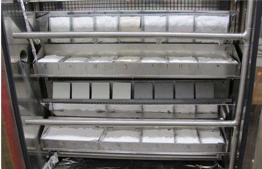
*Abbildung 28: Bewitterungsgerät mit Proben*
