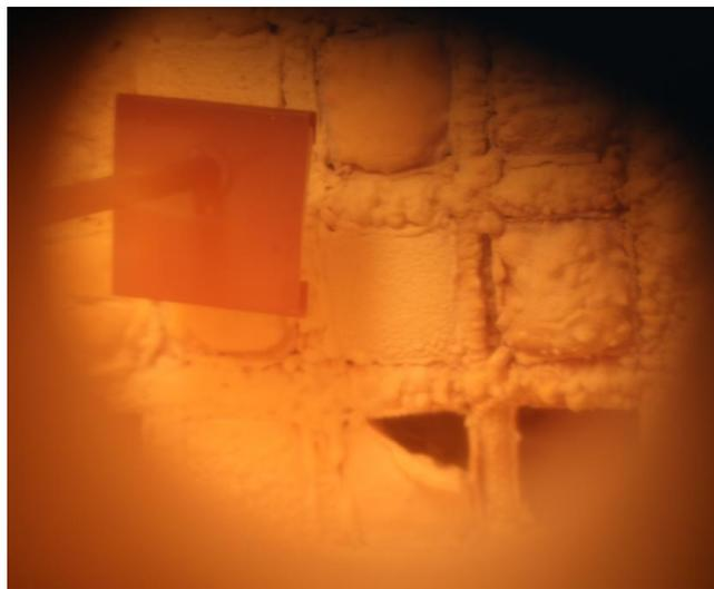
*Abbildung 23: Defekte Beschichtung während des Brandversuchs einer sechsfach bewitterten Beschichtung (6 x Z 01)*
