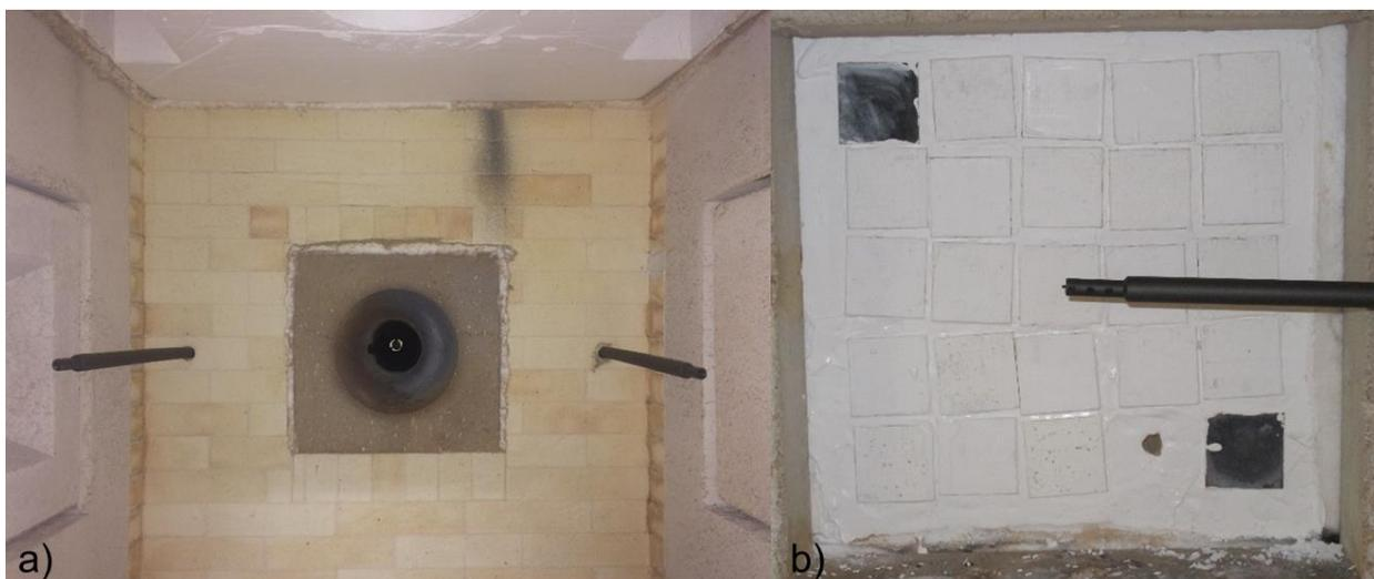
Abbildung 12: a) Innenansicht des Kubikmeterofens, b) Vorderansicht des Probenhalters mit montierten Proben
