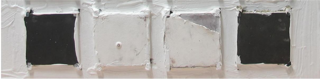
*Abbildung 22: An der Probefalterung befestigte Probekörper, von links nach rechts: unbeschichtete Stahlplatte, einfach bewitterte Beschichtung, sechsfach bewitterte Beschichtung, unbeschichtete Stahlplatte*
