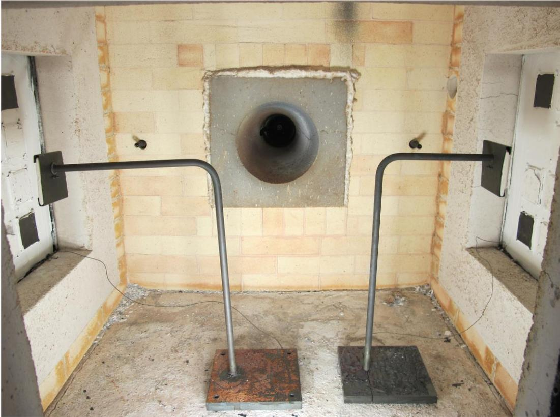
Abbildung 19: Innenansicht des Kubikmeterofens mit integrierten Plattenthermoelementen
