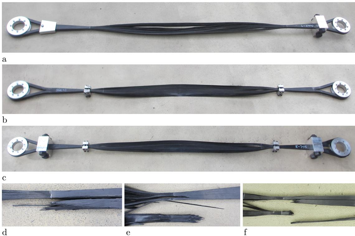
**Abb. 5.26** Thermoplastische Zugglieder und Bruchbilder: a) bis c) Zugglieder 1 bis 3, d) bis f) Bruchbilder der Zugglieder 1 bis 3 am Übergang zwischen Verankerung und freier Länge
