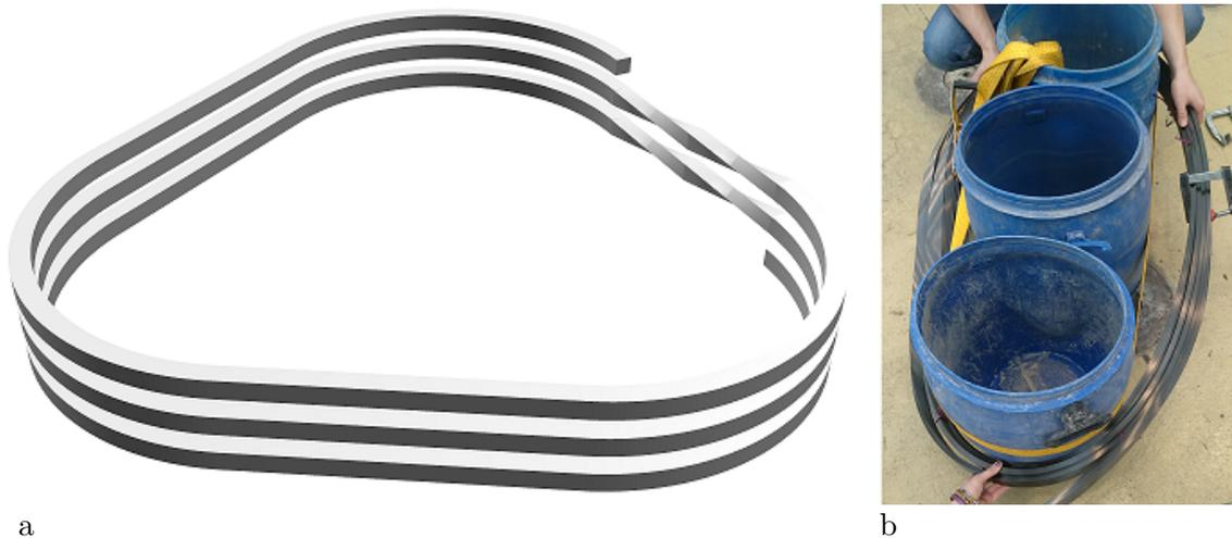
**Abb. 4.8** Wickeln auf Trommeln mit Verdrillen : a) gewickeltes Zugglied mit drei geraden Kanten (Verdrillen entlang einer Kante), b) Wickeln auf eine Trommel mit zwei geraden Kanten [69]
