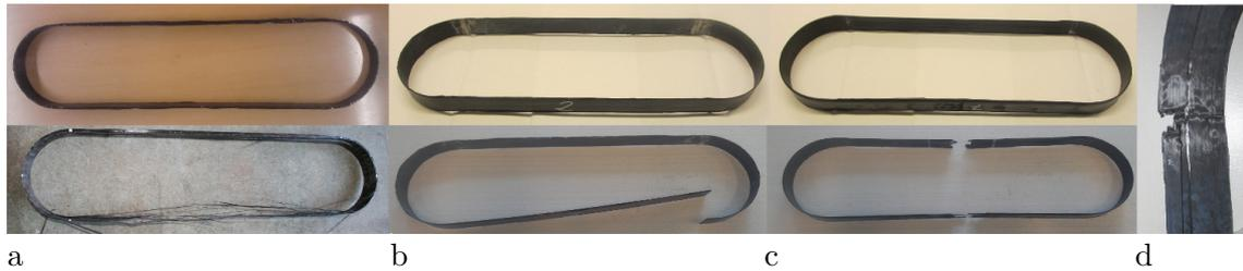
**Abb. 3.15** Verstärkte Schlaufen vor und nach der Belastung: a) verstärkte nassgewickelte Schlaufe, b) unverstärkte Schlaufe aus Prepreg, c) verstärkte Schlaufe aus Prepreg, d) Faserondulation der Schlaufen aus Prepreg am Übergang zur Krümmung
