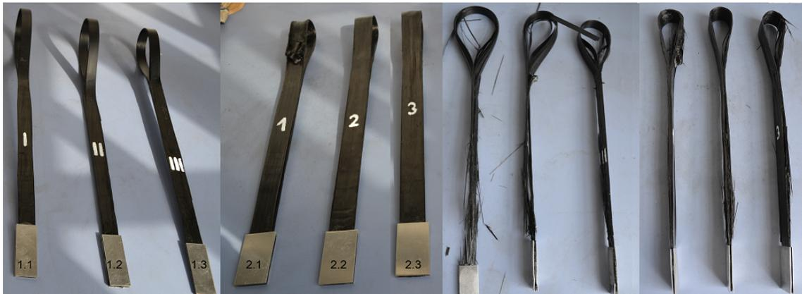
**Abb. 5.8** Handgefertigte thermoplastische Schlingen vor und nach dem Zugversuch [119]
