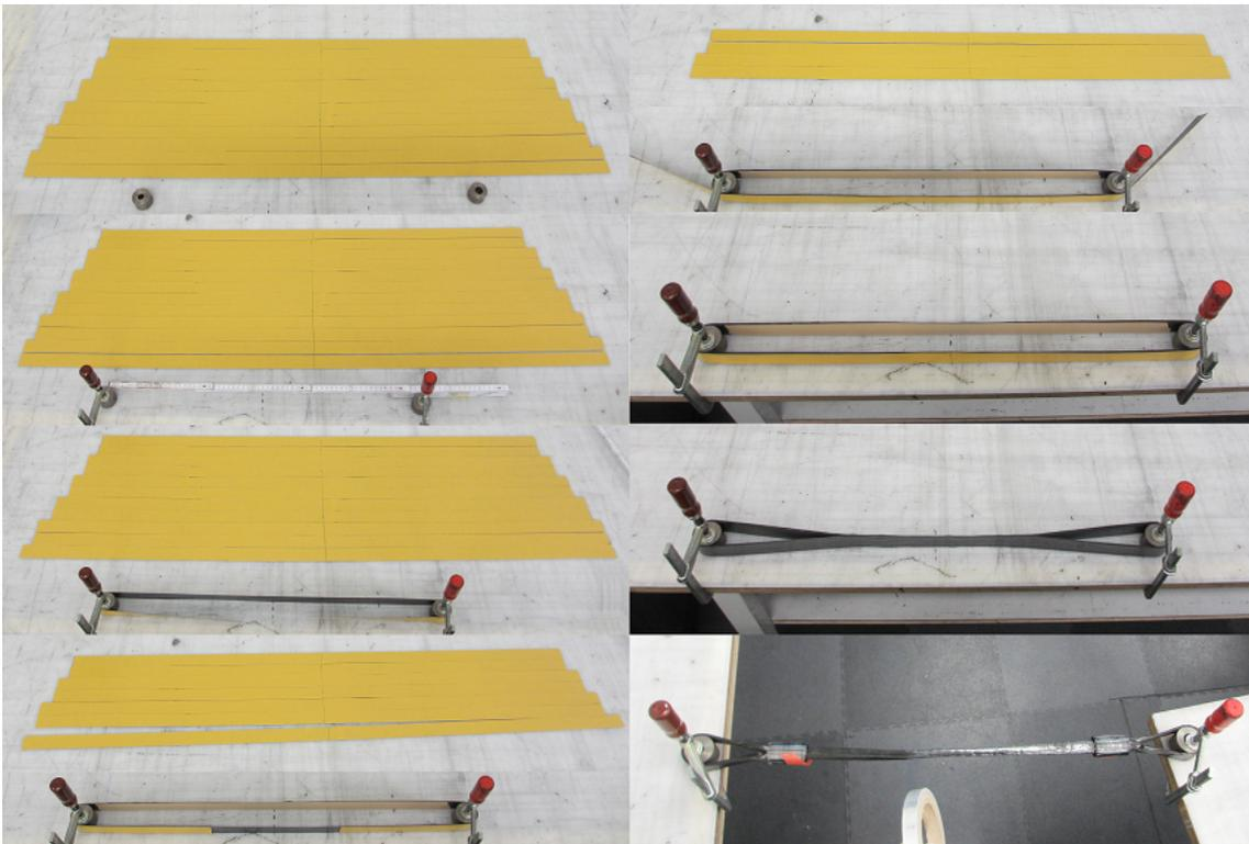
**Abb. 4.12** Herstellung eines Zugglieds 3 aus Prepreg mit zwei Schlingenverankerungen
