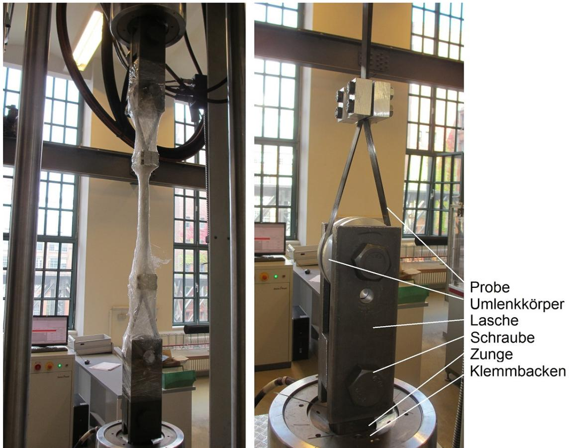
**Abb. 5.1** Zugmaschine Instron 8502 mit Prüfkörper und Adaptern zur Lasteinleitung
