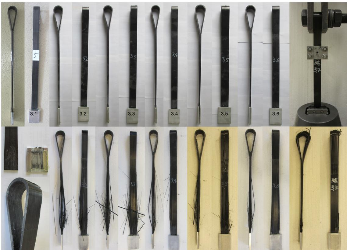
**Abb. 5.10** Gepresste thermoplastische Schlingen vor und nach dem Zugversuch
