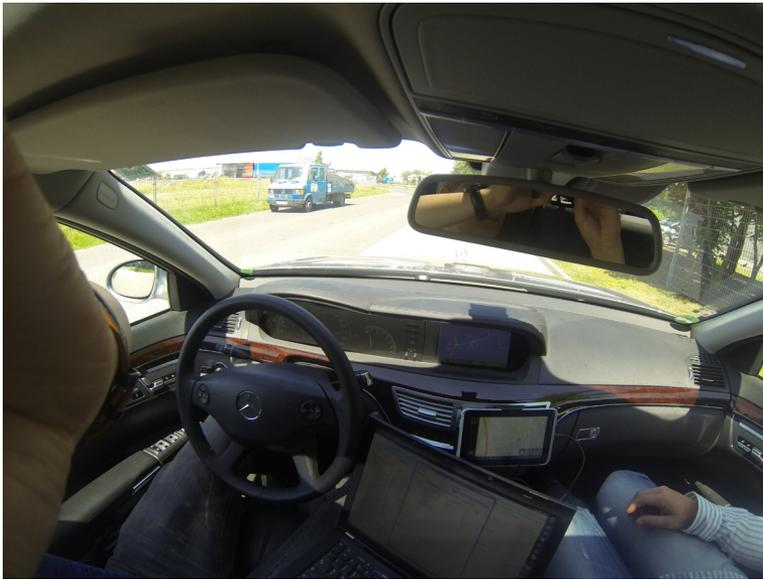
Abb. 6.13: Bild vom Versuchsträger mit HMI-Tablet (angebracht an die Mittelkonsole) und Laptop mit CAN-Anbindung auf dem das lernende System und der adaptive Kurvenwarner ausgeführt wird.
